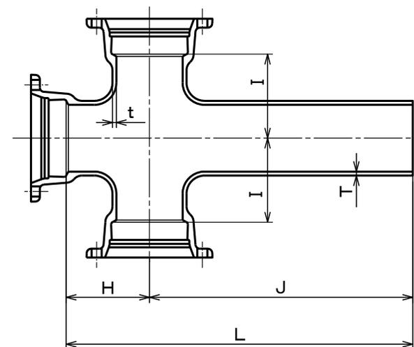
注記1. 本管と枝管との交差部には、丸みを設ける。この場合、内面側の丸みは枝管の管厚 (t) の5倍以上の半径とする。
