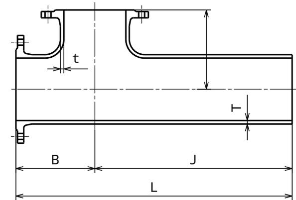
注記1. 本管と枝管との交差部には、丸みを設ける。この場合、内面側の丸みは枝管の管厚 ( t ) の5倍以上の半径とする。
