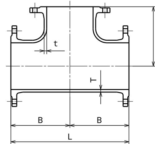
注記1. 本管と枝管との交差部には、丸みを設ける。この場合、内面側の丸みは枝管の管厚 ( t ) の5倍以上の半径とする。
